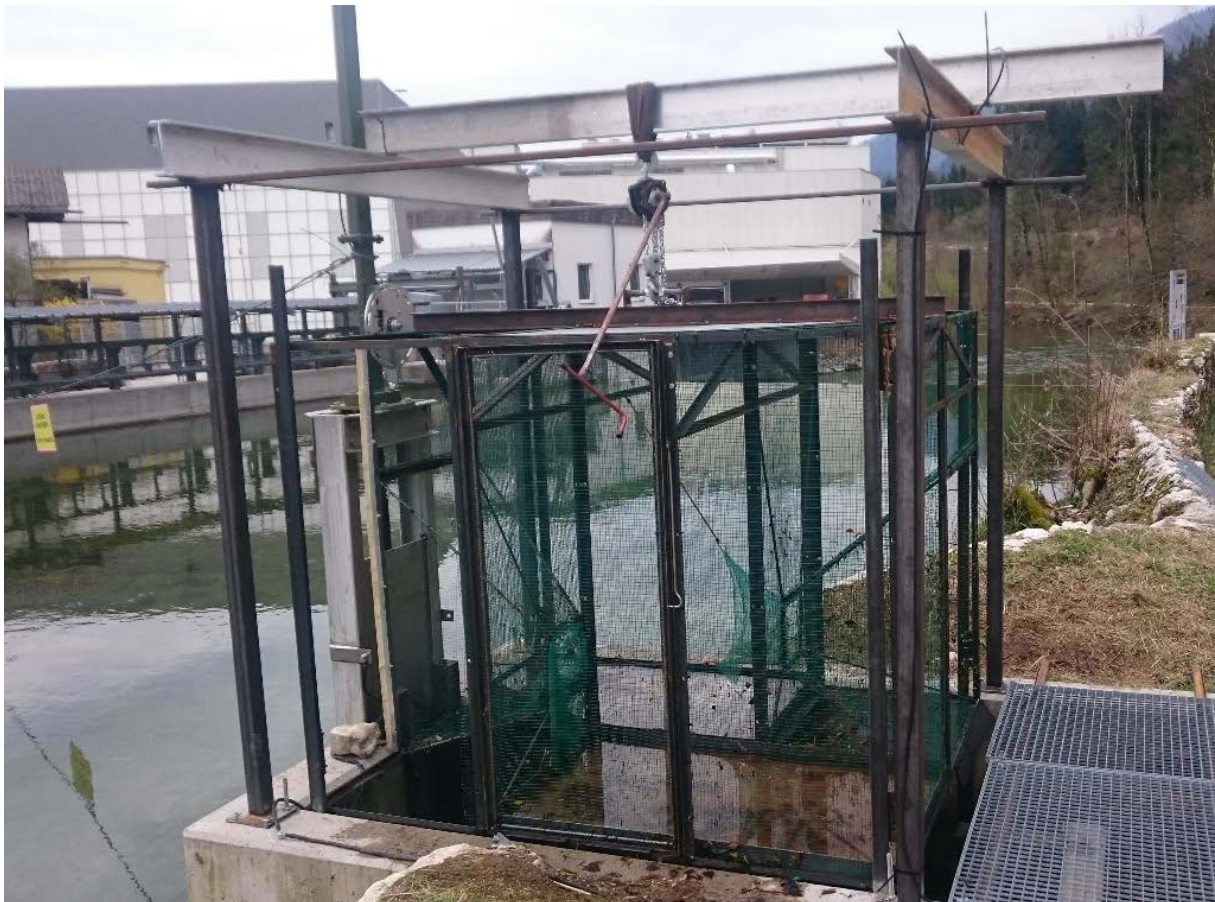
Abbildung 18: Doppelreuse am oberen Ende der FAH Ebewe in gehobener Position zur Entleerung gefangener Fische.
