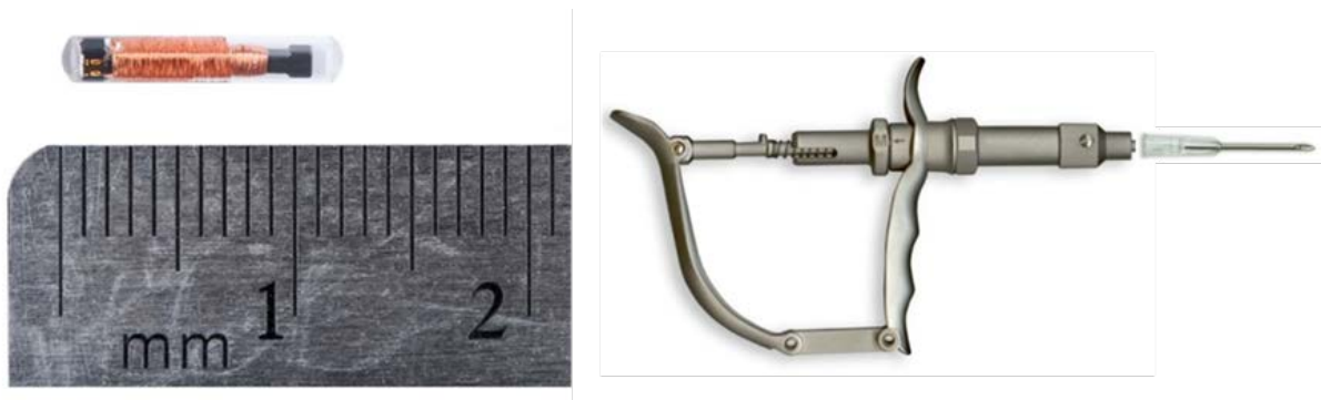
Abbildung 13: links: Passive-Integrated-Transponder (PIT) Tag mit 12 mm Länge. Die Kupferspule dient der Ladung des Chips und Übertragung des individuellen Codes. Rechts: handelsüblicher Injektor für PIT-Tags mit wechselbarer Kanüle.
